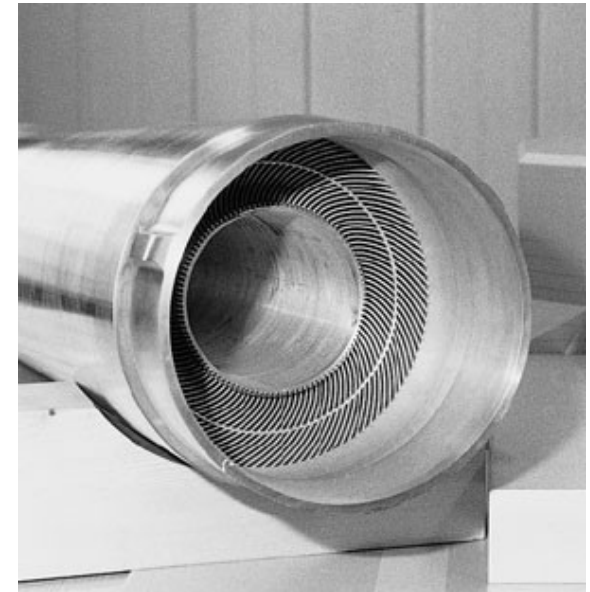
Kompaktkern des FRM II mit Brennstoffplatten (Abbildung: TUM)
